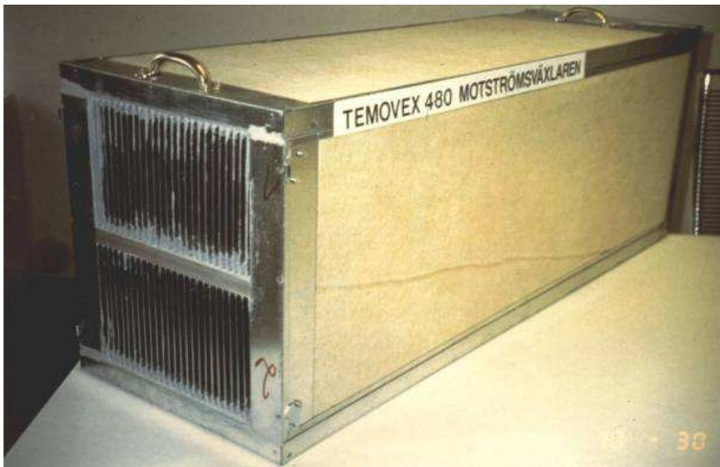
Der verwendete Gegenstrom-Luft-Luft-Warmebertrager fr die Warmeckgewinnung. Die Aufnahme zeigt den Blick auf das Plattenpaket von der Abluftseite/Zuluft-Seite. An dieser Stelle wird der Kasten mit den beiden Geblasen aufgesetzt.
