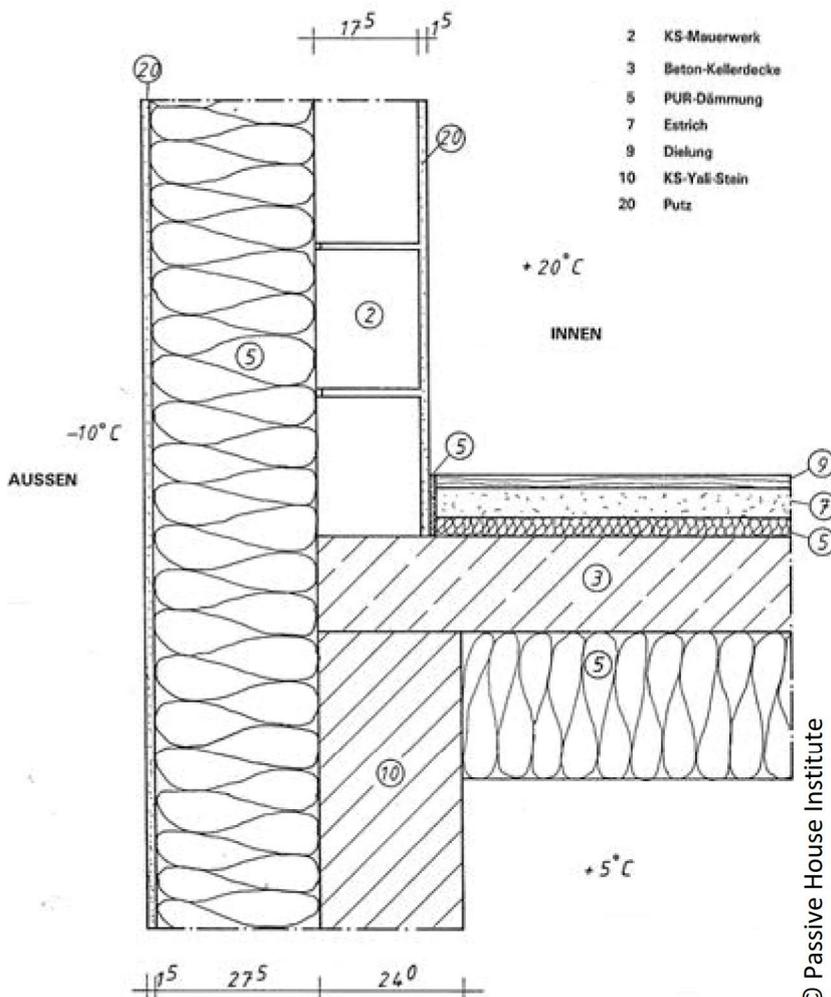
Um die konstruktiv bedingte Wärmebrücke gering zu halten, wird das Kellerwand-Mauerwerk mit einem Stein mit guter Materialdämmung (Porenbetonstein, Nr. ⑩) abgeschlossen
